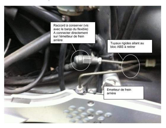
On retire les deux tuyaux rigides qui vont vers le Bloc ABS et on connecte directement le flexible sur l'émetteur du frein
