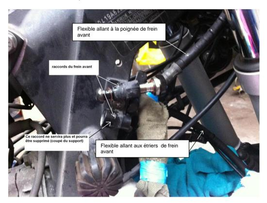
lci, nous avons un double raccord : 2 raccords soudés sur une petite plaque, laquelle est fixée sur la cadre.
