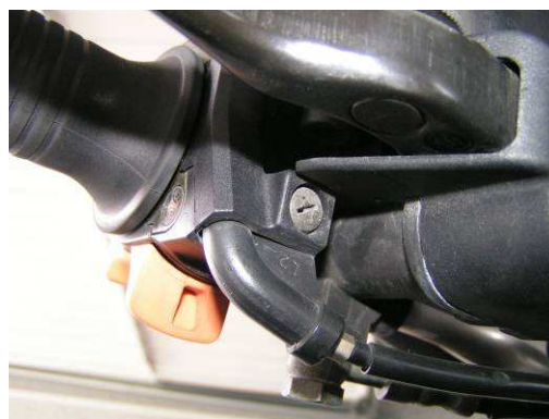
Démontage câble des gaz
